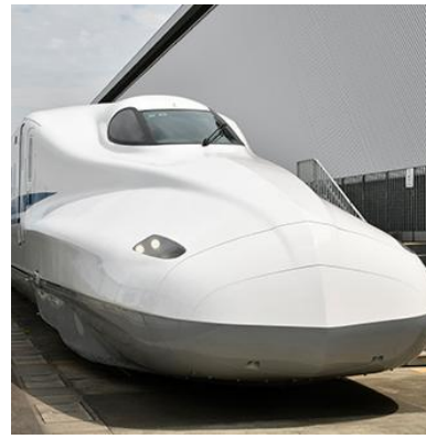
現行の新幹線「N700系」 最高速度:300km/h 編成重量:700トン
