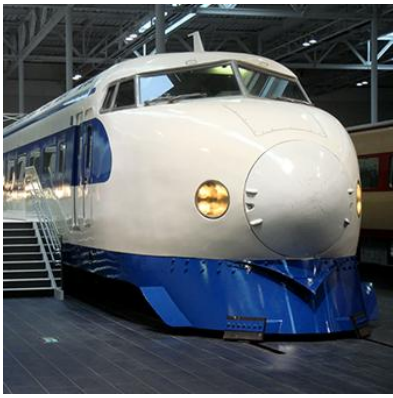
初代新幹線「0系」 最高速度:220km/h 編成重量:970トン
